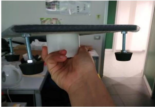
Abbildung 1: Die Vibroplatte ist mit 4 Eisenfüßen (H: 6,5 cm) versehen und ein Mini-Schüttler ist in der Mitte am Boden der Platte angebracht (Foto: Valeria Fattoruso, Fondazione Edmund Mach)
