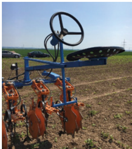
Abbildung 3: Hydraulische Handlenkung der Hacke Quelle: Johannes Diethel
